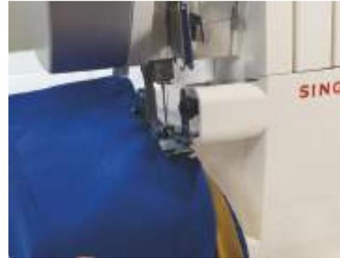
*Nota: in base alla larghezza del margine di cucitura desiderato, si dovrà innestare il coltello per rifilare il tessuto oppure non innestarlo per evitare la rifilatura del margine di cucitura.*
