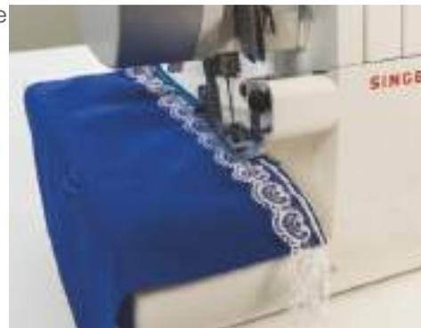
*Nota: se non è necessario rifilare il tessuto, collocare sia il tessuto sia il pizzo sopra la guida. Disinnestare il coltello. Regolare la guida e cucire.*
